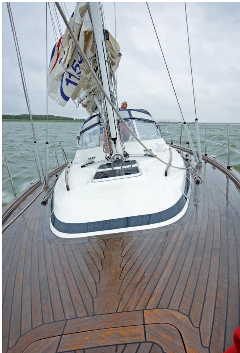
Der Aufbau erhebt sich unaufdringlich aus dem Deck mit seinen großzügigen Freiflächen – das blaue Band kaschiert die seitlichen Fensterzeilen ein.
