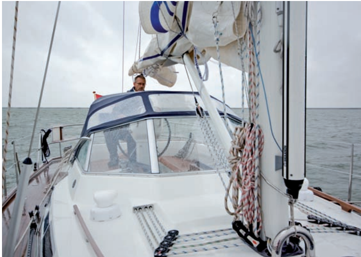
Das Cockpit vermittelt insgesamt einen sehr guten Schutz vor Wetter und See – die feste Scheibe mit angeschlossener Sprayhood hält den anpeitschenden Regen effektiv ab.
