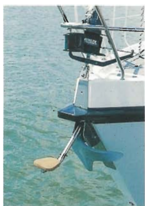
Hoog vrijboord noopt tot inventiviteit: een opstapje op het anker.
